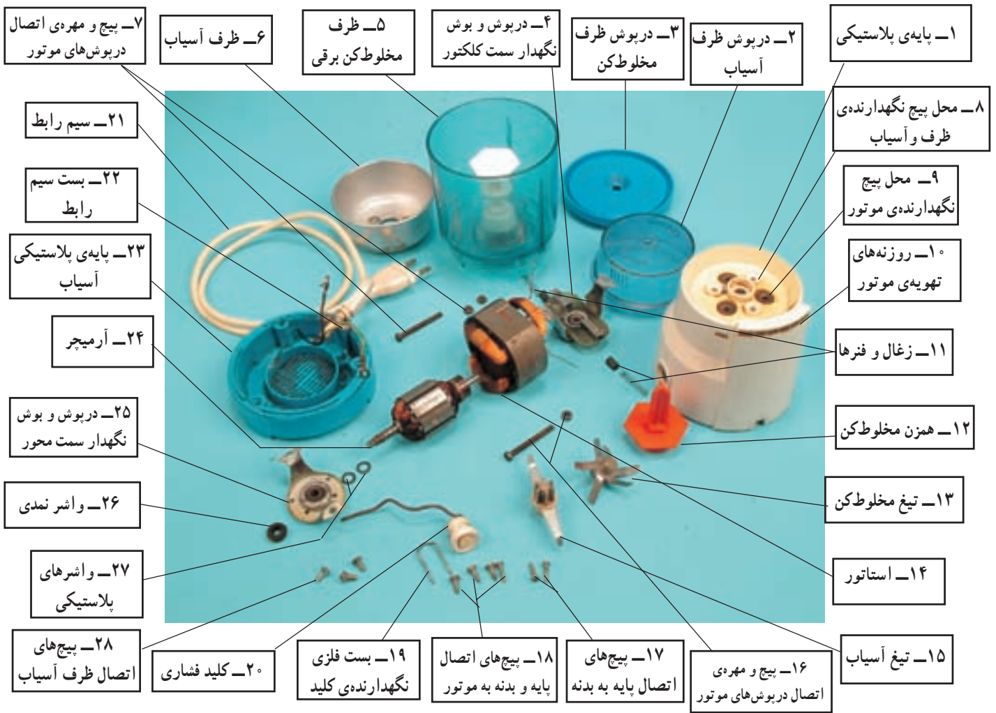
شکل ۴-۳۲- اجزای ساختمانی یک نمونه مخلوط‌کن برقی
