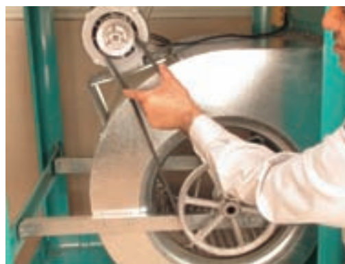
الف- طرز قرار گرفتن تسمه روی پولی‌ها
