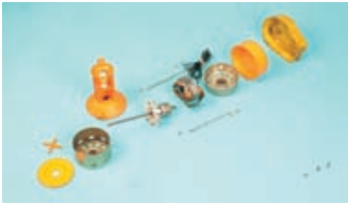
شکل ۱۸-۸ - نمایش ظاهری و اجزای یک واترپمپ
